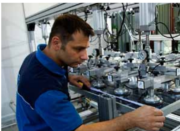
Opstelling voor dynamische windbelastingstest
