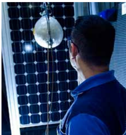
Impact test op een zonnestroomsysteem
